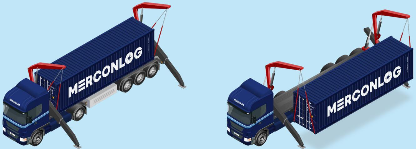
Seitenlader können Container ohne zusätzliche Ausrüstung und in kurzer Zeit auf- und abladen sowie von einem Chassis auf ein anderes oder von einem Chassis auf einen Anhänger oder Bahnwaggon umladen.
